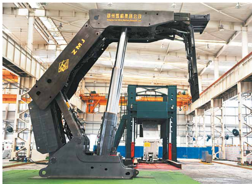
Самая высокая секция механизированной крепи в мире производства ZMJ, испытательный цех
